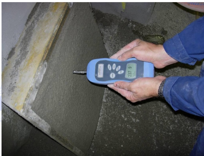
Hình A.3 Dùng xuyên kế (penetrometer) để đo cường độ sớm của bê tông phun
